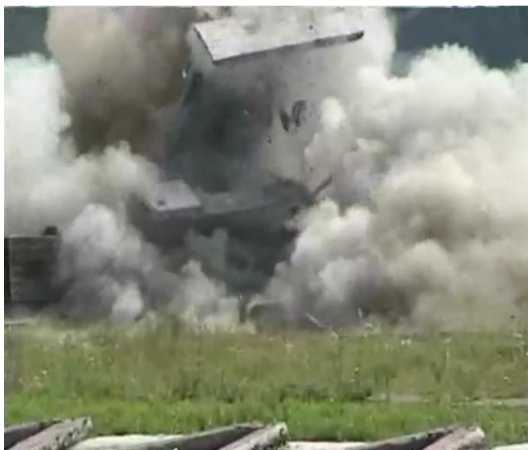
Рис. 87. Результат попадания РШГ-1 во внутрь железобетонного укрытия.
