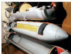
Авиабомба для ночной аэрофотосъемки ФОТАБ-250Т
