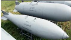
Форма авиабомб для наружной подвески была предложена В. В. Моторинъм. В отличие от ранее принятых в ФАБах эта модель имела обтекаемую головную часть, удлиненный хвостовой конус с малым углом конусности, минимальные размахи и длину стабилизатора.
