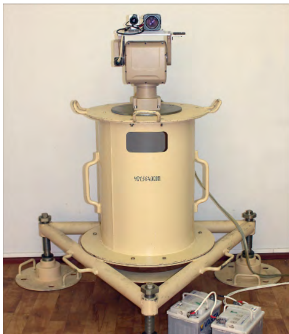
Автономный комплекс регистрации и измерения параметров движения авиационной бомбы
