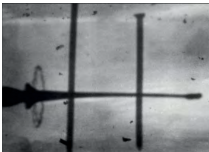
Рентгенограммы кумулятивных струй малокалиберных боеприпасов
