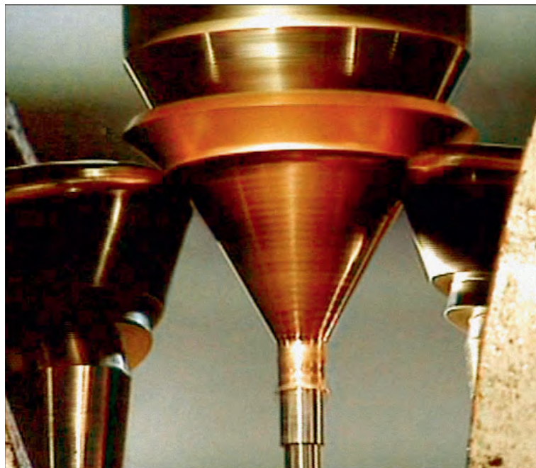
Ротационная вытяжка кумулятивной облицовки
