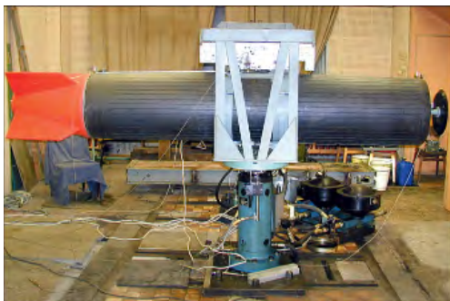
Вибрационные испытания авиационной кассеты РБК-500 Вибрационные испытания авиационного средства пожаротушения АСП-500
