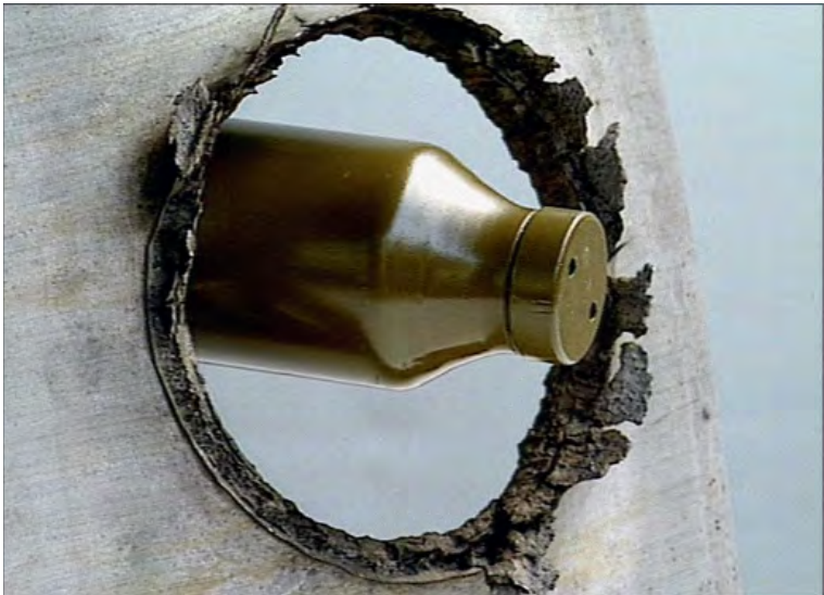
Результат действия термобарического боеприпаса с трансформируемой оболочкой
