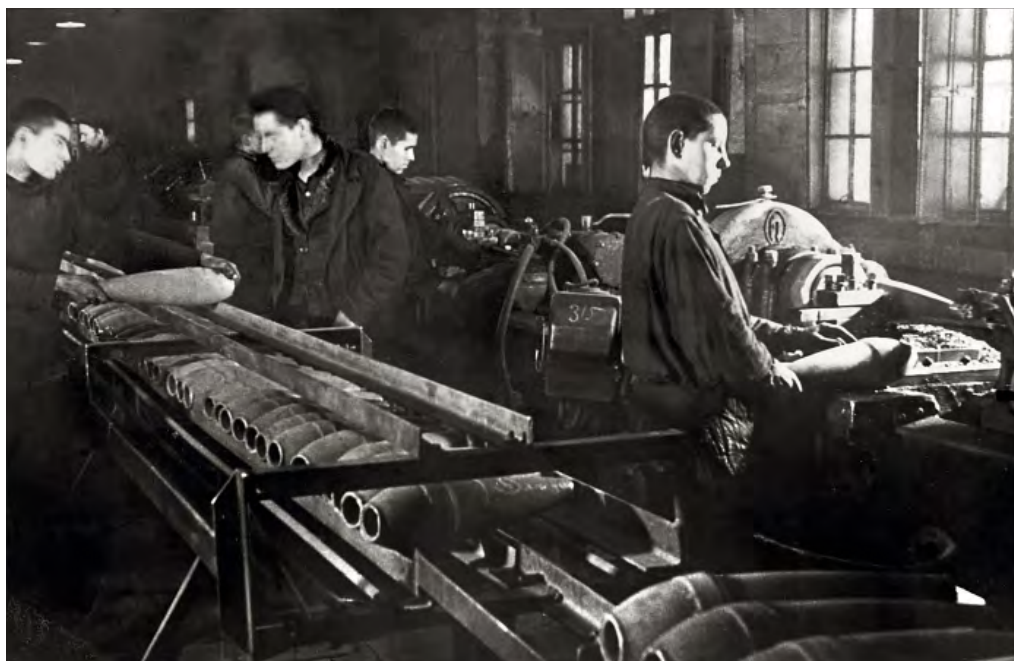
Производство корпусов 120-мм мин
