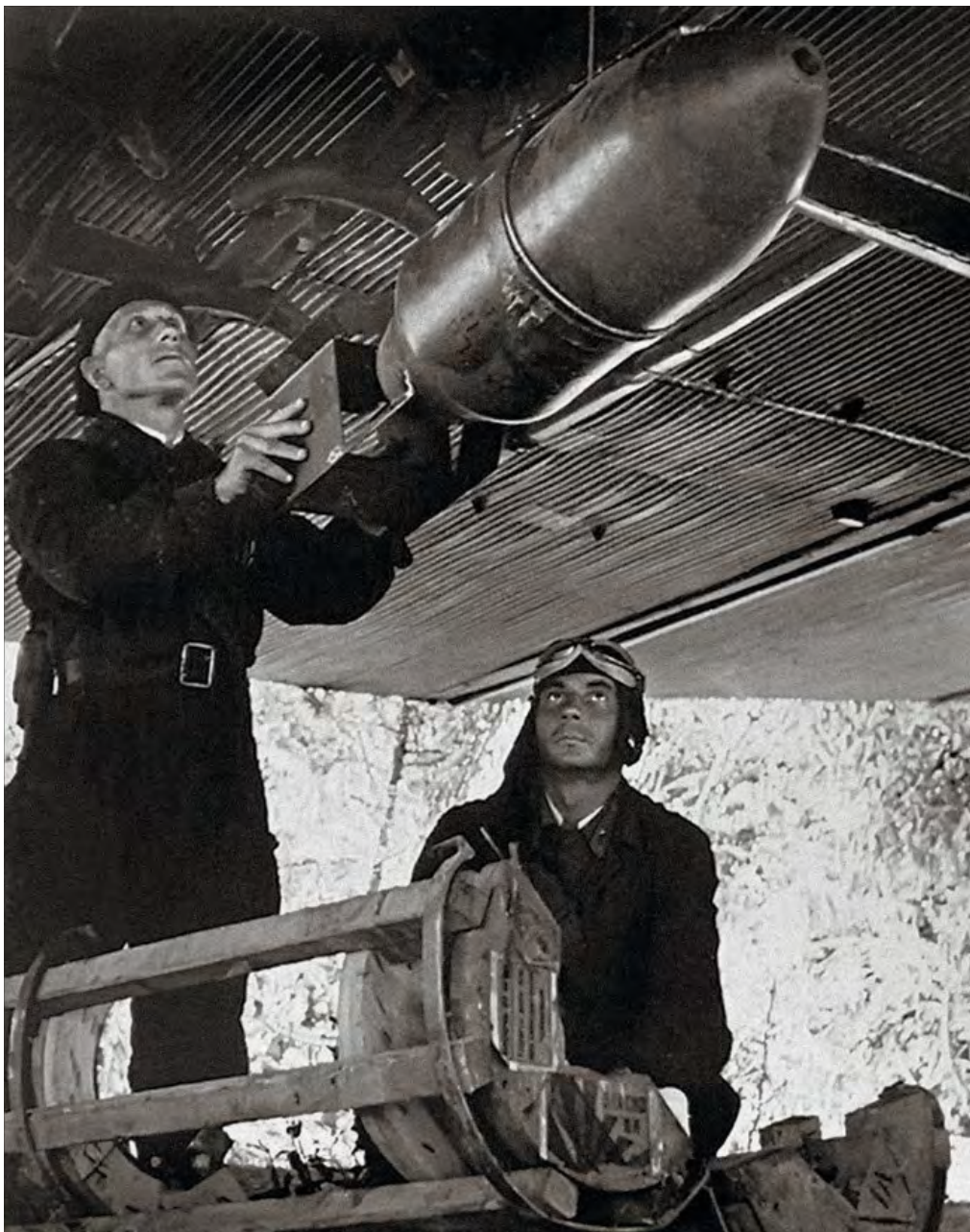
Подвеска зажигательной бомбы ЗАБ-100ЦК под самолет
