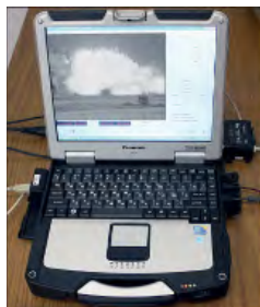
Автономный комплекс регистрации и измерения параметров движения авиационной бомбы
